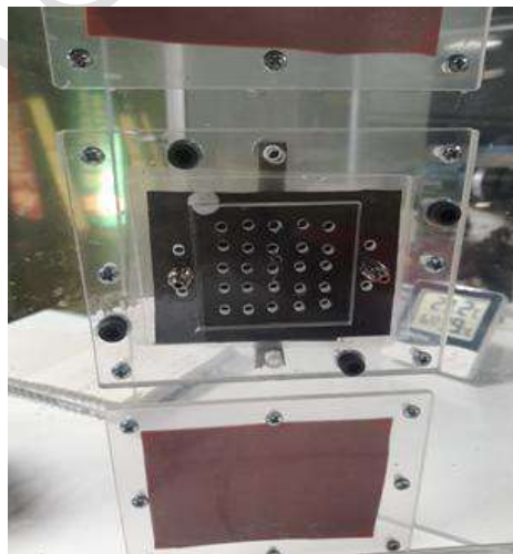
Şekil 1. Solid-State Dehumidifier sisteminde kullanılan hücre düzeneği
