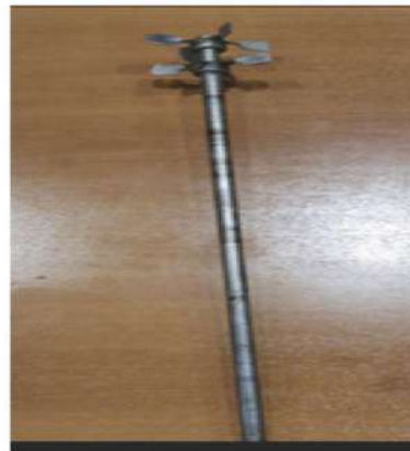
Şekil 1. Deneysel çalışmalarda kullanılan karıştırıcı ve bıçak tipi
