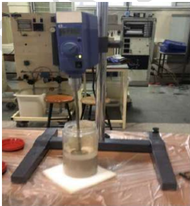
Şekil 1. Deneysel çalışmalarda kullanılan karıştırıcı ve bıçak tipi
